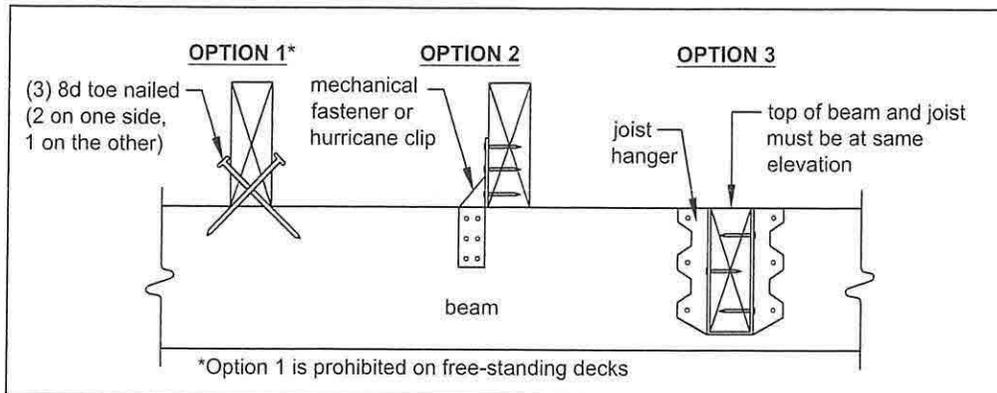
FIGURE 8: JOIST-TO-BEAM DETAIL
